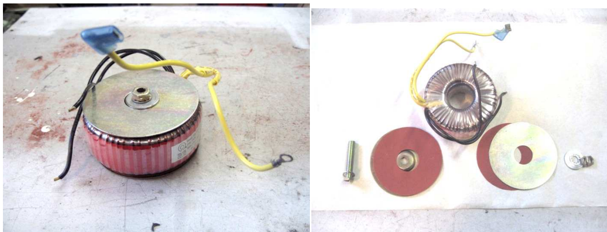
Kuva 4: Tyypillinen toroidimuuntaja (1 toisiokäämi)
