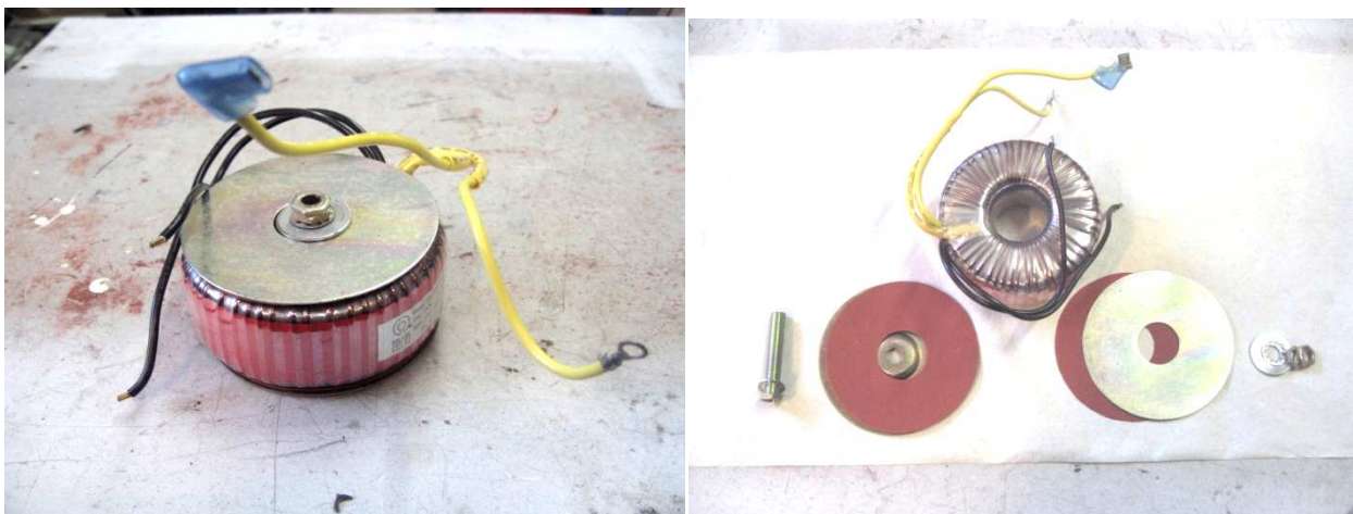
Kuva 4: Tyypillinen toroidimuuntaja (1 toisiokäämi)
