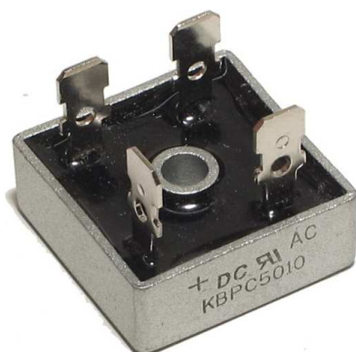
Kuva 14: Tyypillinen kokoaaltodiodisilta
