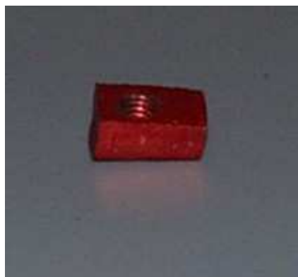
Kuva 3: Kierteytetty alumiinipala, jossa anodisoitunut kierre näkyvissä.
